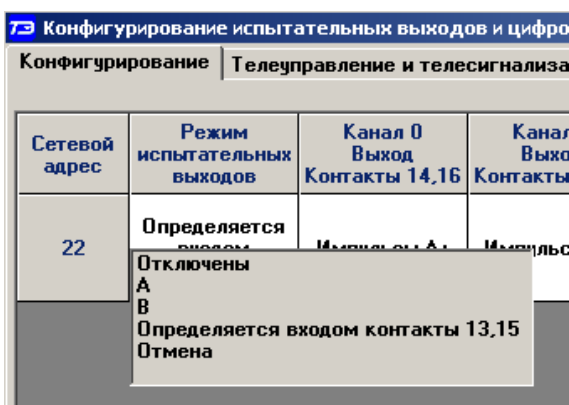
Рисунок 43 – Конфигурирование режимов испытательных выходов
